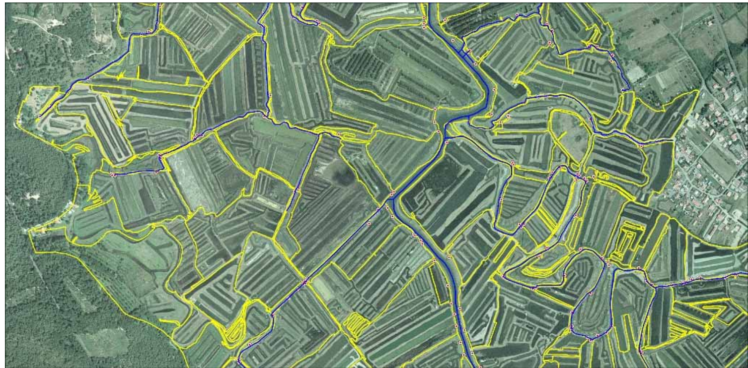
Le marais des Olonnes : modélisation du réseau hydraulique
