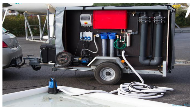
Figure 17 : Dispositif de carénage mobile carenecolo (source : www.carenecolo.fr ).
