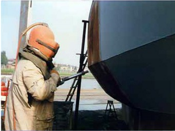
Figure 14 : Sablage d'un bateau (Source: www.banik.com dans Cetmef, 2011))
