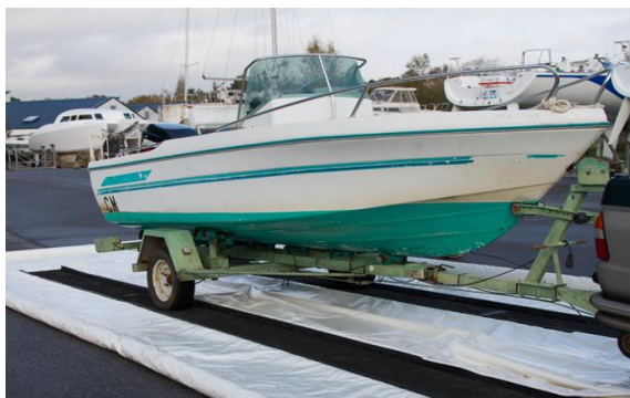
Figure 17 : Dispositif de carénage mobile carenecolo (source : www.carenecolo.fr ).
