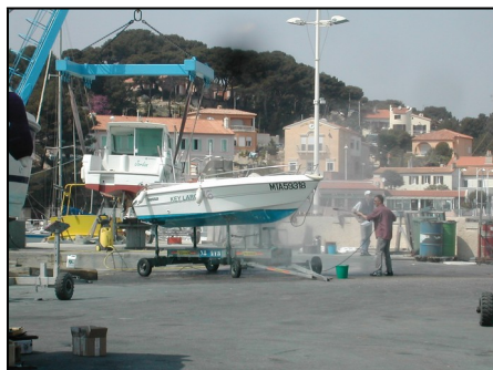
Figure 4 : Nettoyage de la coque à l'aide d'un nettoyeur à haute pression (Source : Cetmef, 2005)
