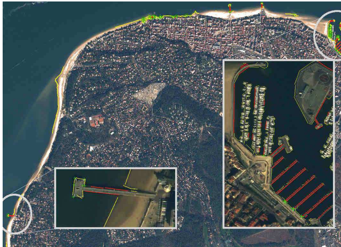
Traitement d'une image Geoeye (Arcachon) : détection de l'artificialisation du Trait de Côte matérialisée par les angles droits (vert) et les segments parallèles (rouge) (Fonatanaz 2012 ; Nasser, 2011)
